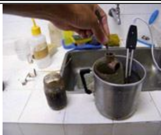
Fig. 9-10. Processo de preparação do cotovelo de PVC. Primeiro no banho de cera e segundo na própolis.
